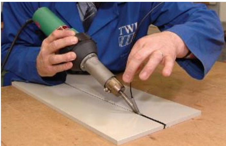
Joonis 6. Kuuma gaasiga keevitus [14]
