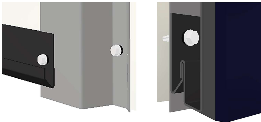
Sele 3.14 Stardiliistu kinnitamine roovil (vasakul) ja stardiliistu ning kasseti vahelise ühenduse ristlõige (paremal)
