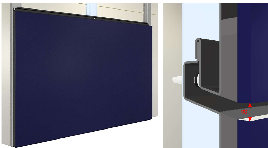
Sele 3.15 Esimese kasseti kinnitamine roovide külge (vasakul) ja kahe kasseti vahelise ühenduse ristlõige (paremal)
