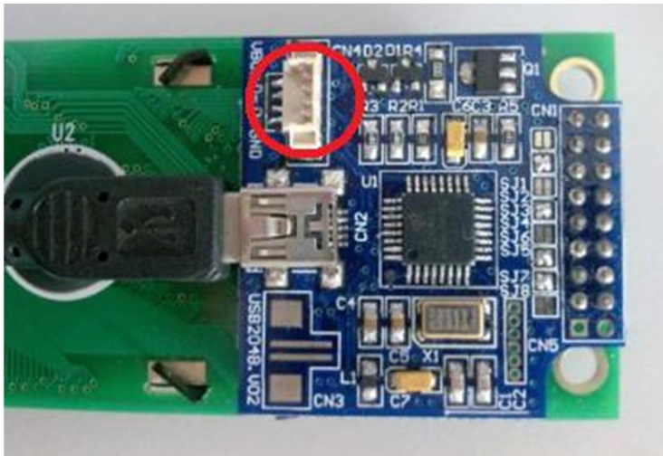
Joonis 2.2 USB ühendused vedelkristallerkaani tagumisel küljel
