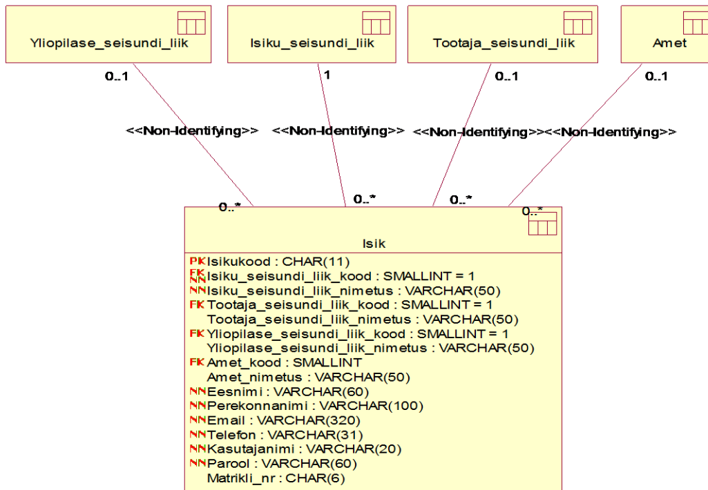
Joonis 10. Denormaliseeritud andmebaasi isikute registri füüsilise disaini andmebaasi diagramm (UML notatsioonis).
