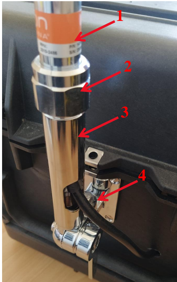
Joonis 19. Antenn (1), kinnitusmutter (2), adapter toru (3), neljasuunaline kinnitus (4)
