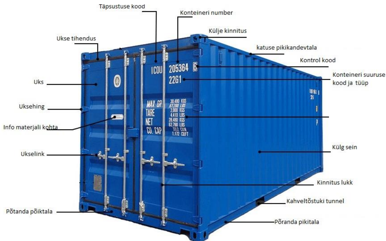
Joonis 1.1 Merekonteineri koostisosad [14]
