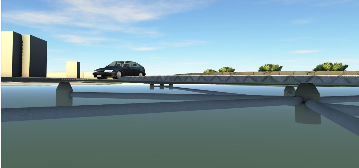
Joonis 8: Sajuveekanaliseerimise näide
