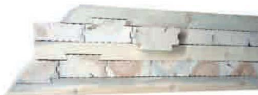
Joonis 1.3. Ristkihtpuidu kihid ühendatud keelte, soonte ja kalasabatappide abil [6]
