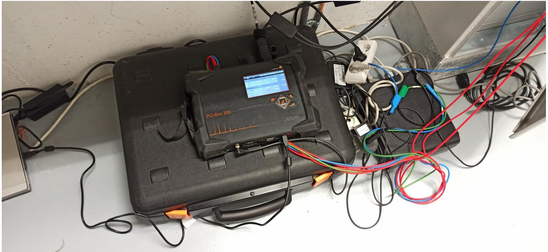
Lisa 7 Esimeses seksioonis kasutatud mõõteseade – A-Eberle PQ-Box 300
