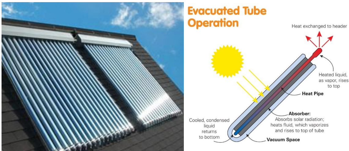
Joonis 2.2. Vaakumtorudega kollektori tehnoloogia (15)
