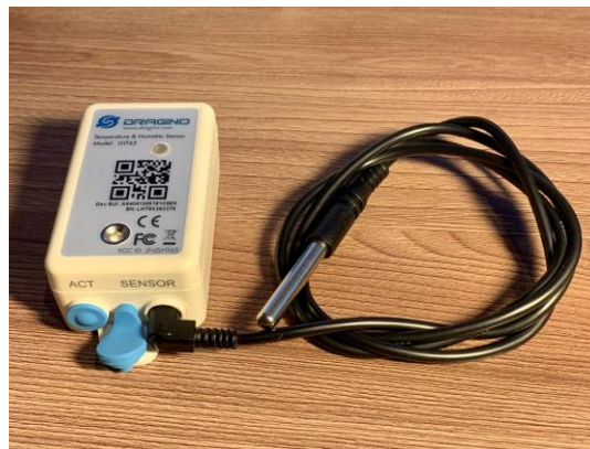
Joonis 3.8 LHT65 nupp ACT ja SENSOR pesa
