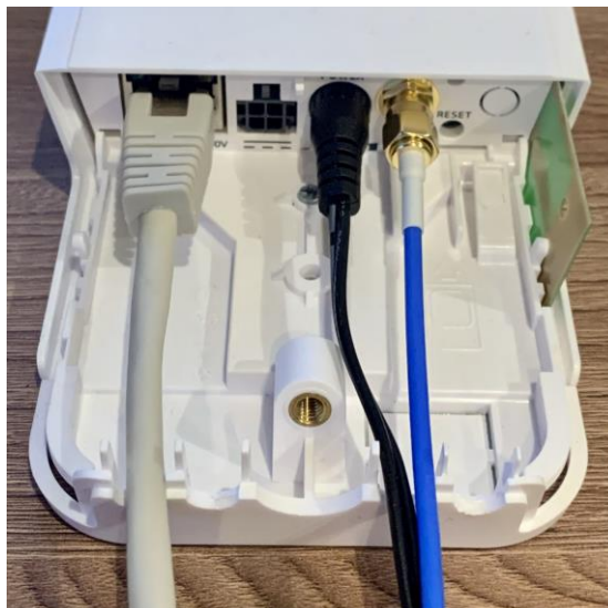
Joonis 3.1 juhtme ühendus WAP LR8 korgi all. Vasakult paremale: Ethernet juhe, toitejuhe, antennijuhe
