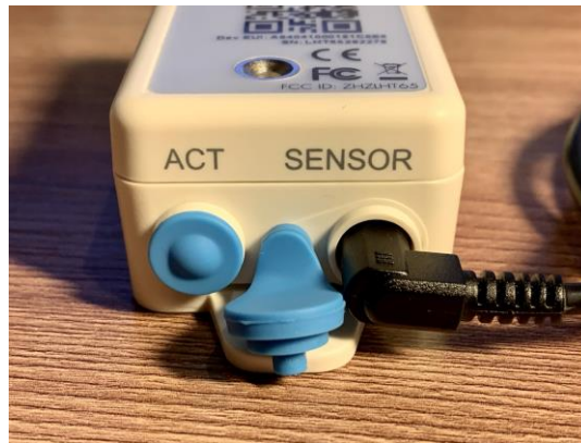
Joonis 3.8 LHT65 nupp ACT ja SENSOR pesa
