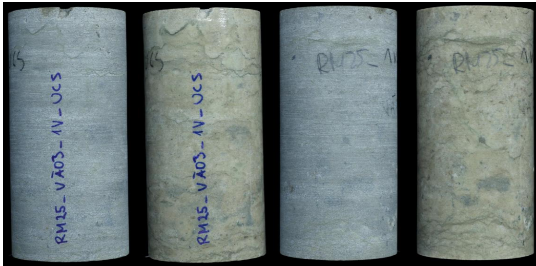
Joonis 7. VÄO3 UCS proovikeha, mõõtmetega d \approx 54 mm ja h \approx 108 mm (11.02.2026 R.Männik).
