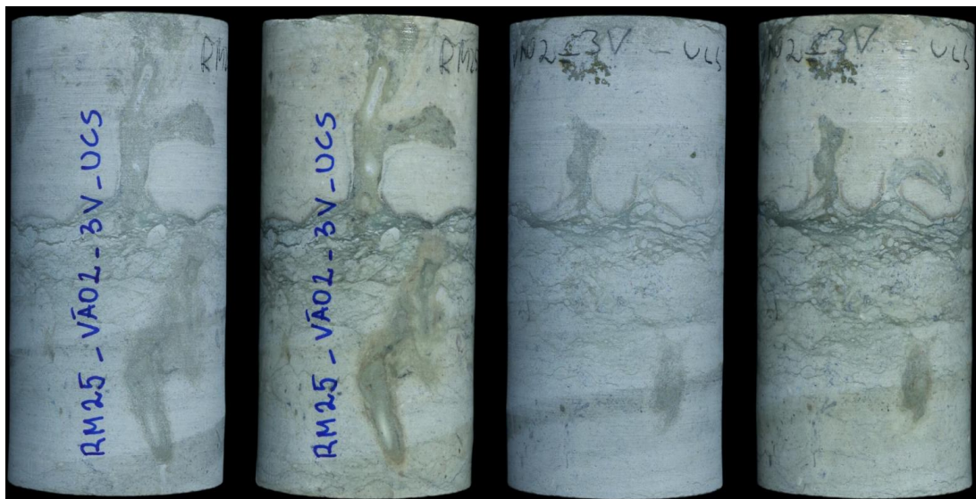
Joonis 6. VÄ02 UCS proovikeha, mõõtmetega d \approx 54 mm ja h \approx 108 mm (11.02.2026 R. Männik).
