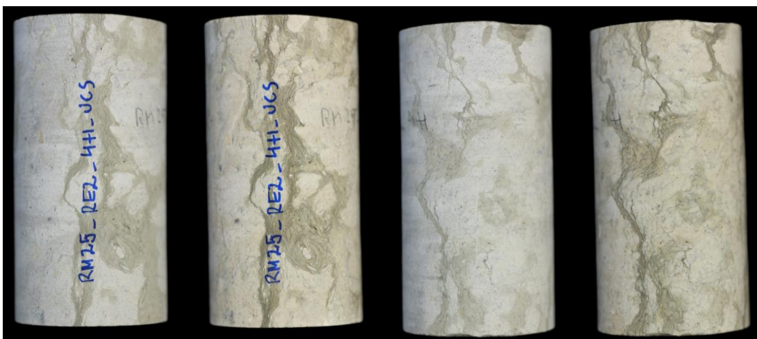
Joonis 11. RE2 UCS proovikeha, mõõtmetega d \approx 54 mm ja h \approx 108 mm (05.03.2026 R.Männik).
