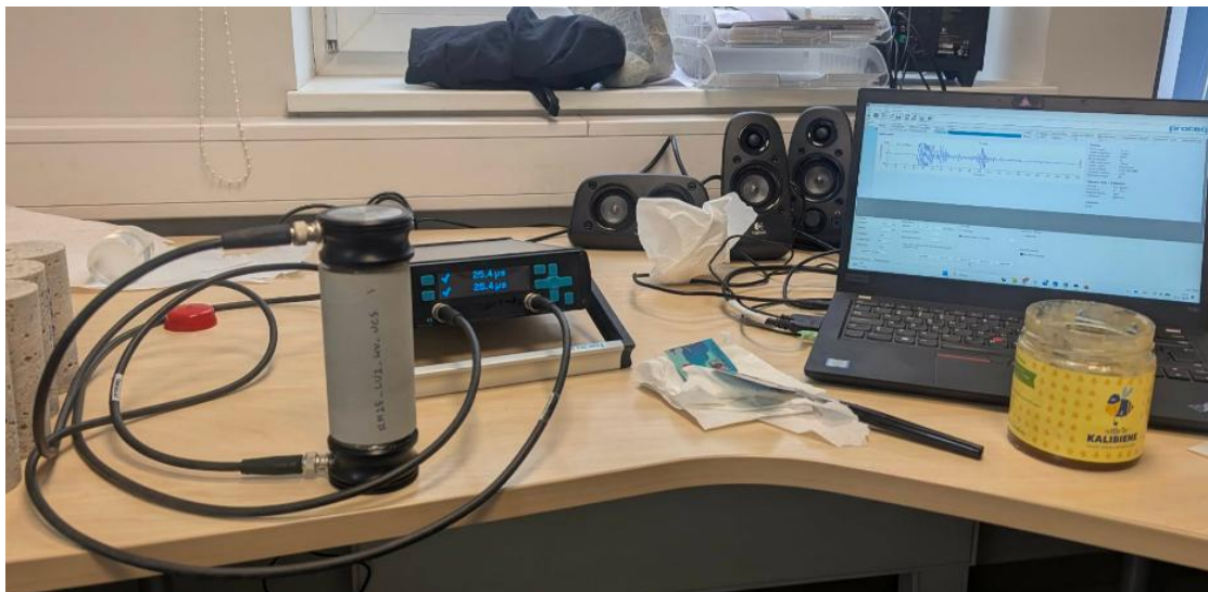
Joonis 28. Ultraheli mõõteseadme Pundit Lab+ katseseadistus koos proovikehaga; transduktorite ja proovipinna vahelise kontakti parandamiseks kasutati sidusainena mett (R. Männik 17.03.2026).
