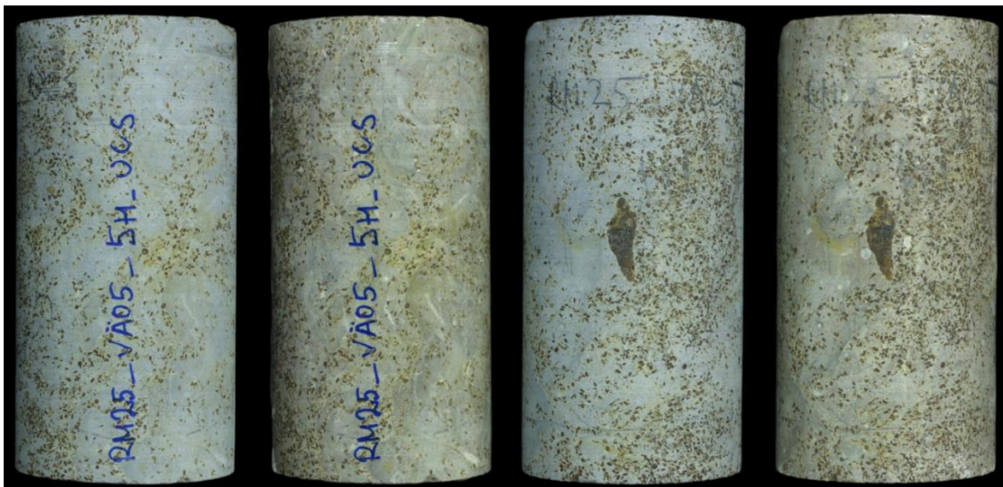
Joonis 9. VÄ05 UCS proovikeha, mõõtmetega d \approx 54 mm ja h \approx 108 mm (11.02.2026 R.Männik).
