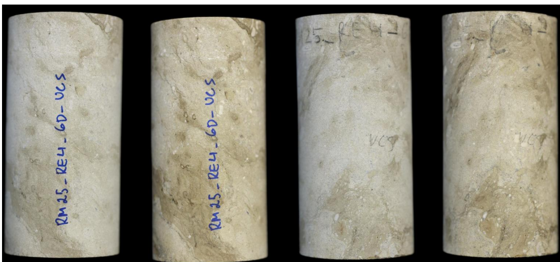
Joonis 13. RE4 UCS proovikeha, mõõtmetega d \approx 54 mm ja h \approx 108 mm (05.03.2026 R.Männik).
