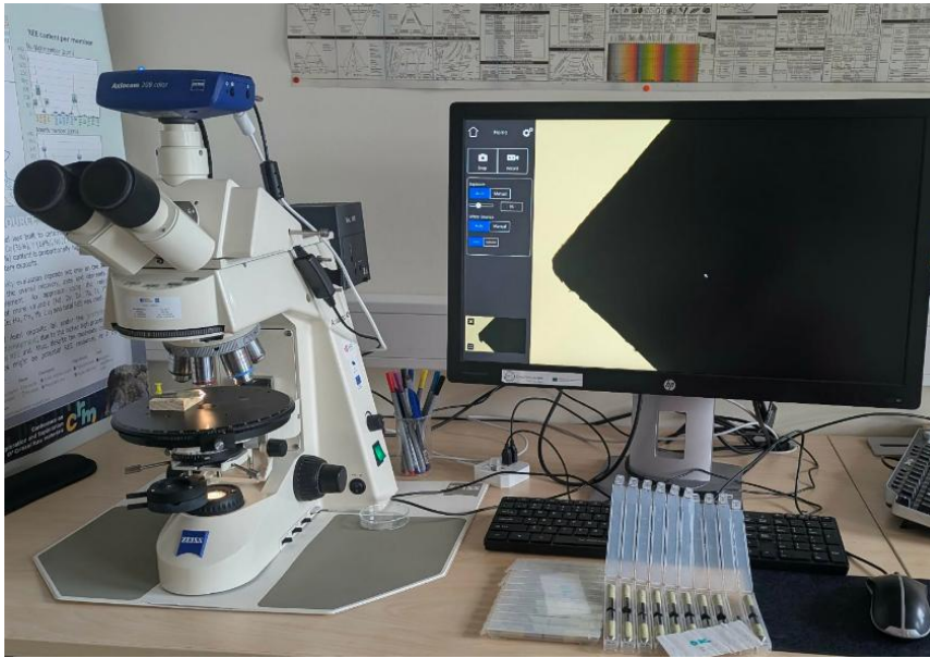
Joonis 26. CERCHARi katse käigus kulunud terasnõelte otste dokumenteerimine mikroskoobiga (R. Männik 18.03.2026).
