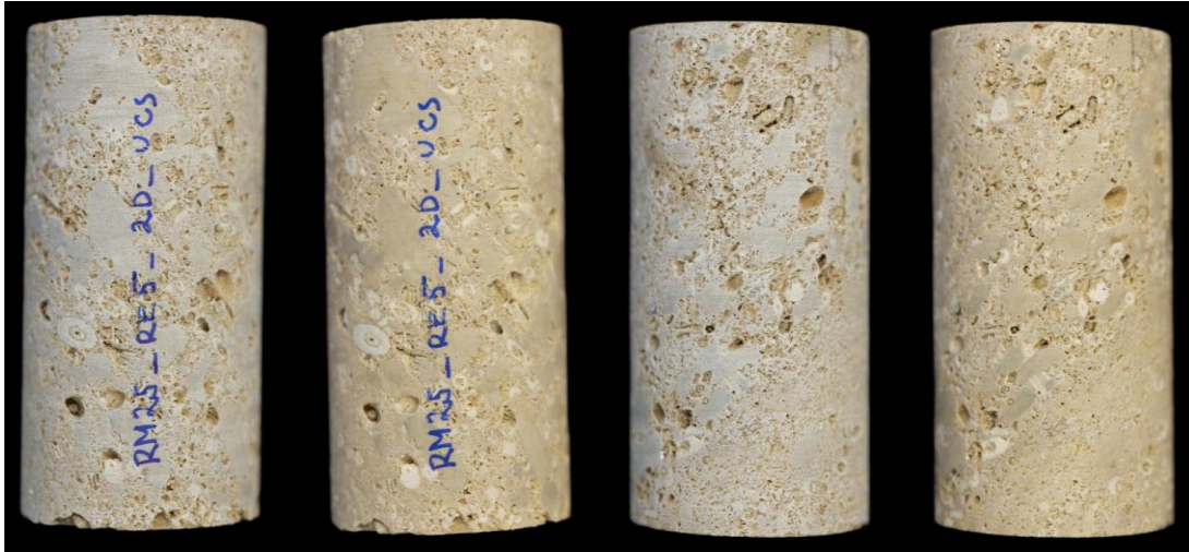
Joonis 14. RE5 UCS proovikeha, mõõtmetega d \approx 54 mm ja h \approx 108 mm (05.03.2026 R.Männik).
