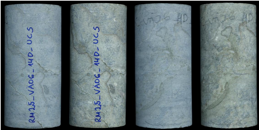
Joonis 10. VÄO6 UCS proovikeha, mõõtmetega d \approx 54 mm ja h \approx 108 mm (11.02.2026 R.Männik).
