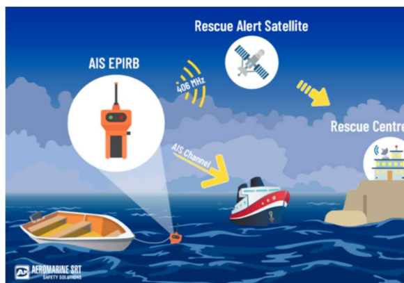
Joonis 2.4 EPIRB-AIS ja tööpõhimõte [13]
