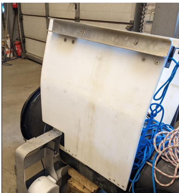
Joonis 27. Tiivad sirgeks painutav U-profiil. Foto: Taaniel Reimers
