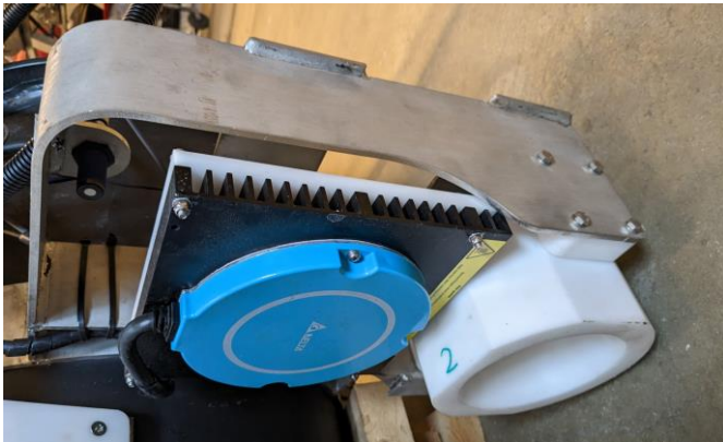
Joonis 21. Laadimisplaat ja koonus metallkonstruktsiooni küljes. Foto: Taaniel Reimers
