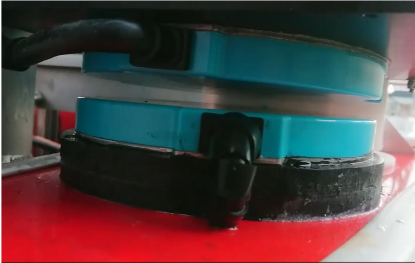
Joonis 36. Laadimisplaatide akontaktsus. Foto: Taaniel Reimers
