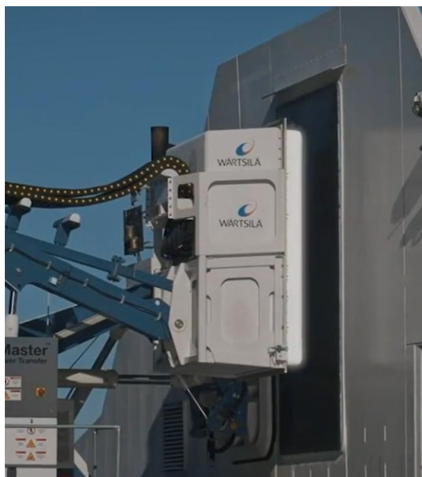
Joonis 3. Wärtsilä juhtmevaba laadimisplakk lähenemas laevale. Foto: tootja
