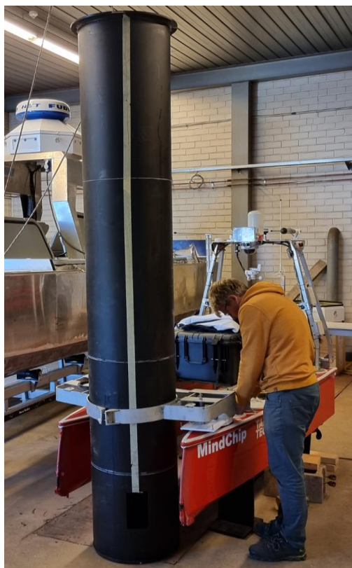
Joonis 28. Mõõdistustööd koonuste ja laadimisplaadi kinnitamiseks. Foto: Egert Lass
