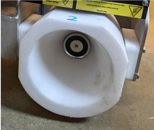
Joonis 35. Koonuse põhjas olev elektromagnet. Foto: Taaniel Reimers
