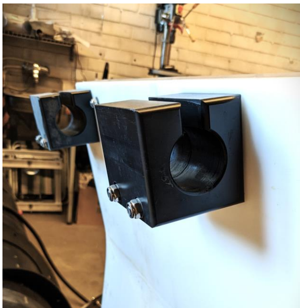
Joonis 26. Tiibade küljes olevad juhtklotsid. Foto: Taaniel Reimers
