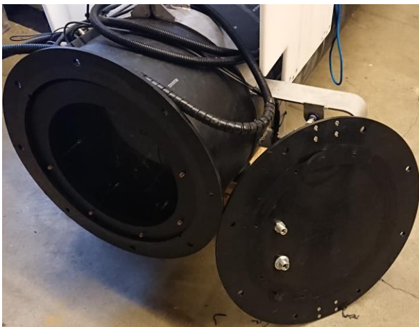
Joonis 33. Postamendi kaane ja sisu ühenduse katkemine. Foto: Taaniel Reimers
