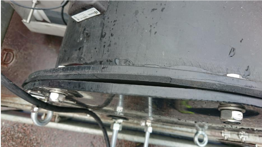
Joonis 32. Lainetav ja mitteveetihe ühenduskoht silindri krae ja sisepostamendi vahel. Foto: Taaniel Reimers
