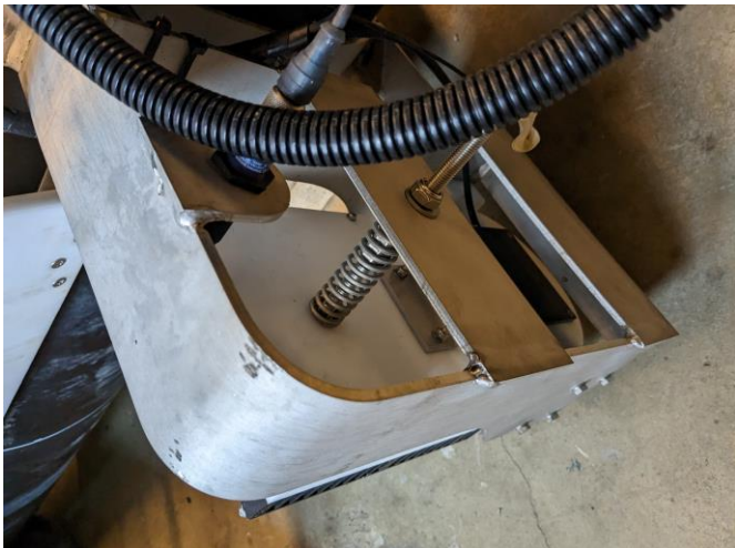
Joonis 21. Laadimisplaat ja koonus metallkonstruktsiooni küljes. Foto: Taaniel Reimers
