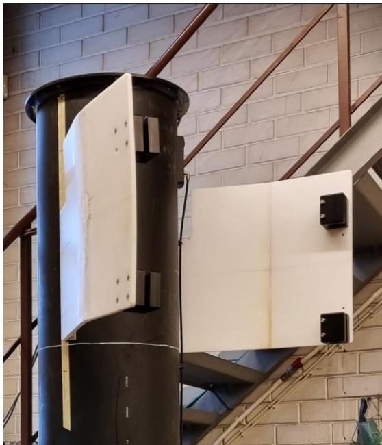
Joonis 24. Silinder-kai ühenduse tagavad „Tiivad“. Foto: Egert Lass
