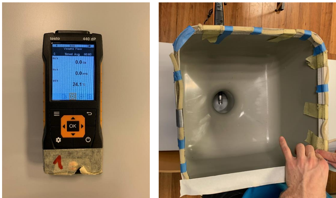
Joonis 4.3 Mõõteseade Testo 440 ning mõõdistuskast koos külge ühendatud anduriga, nende abil oli võimalik mõõta väljatõmbe plafoonide õhuvoolu hulka.
