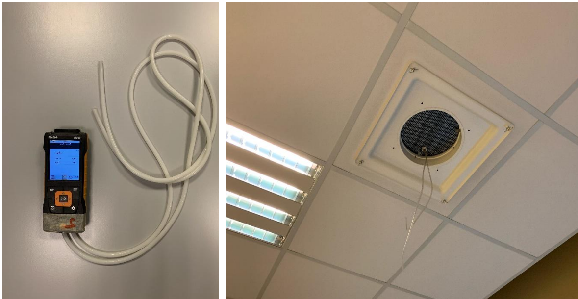
Joonis 4.2 Mõõteseade Testo 440, millega oli võimalik mõõta sissepuhke plafoonide rõhulangu.
