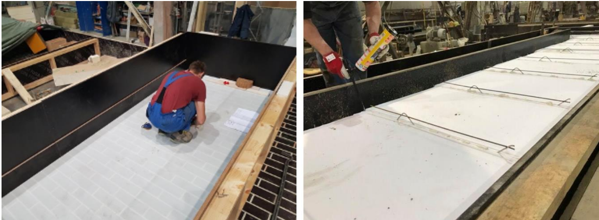
Joonis 3.2 Raudbetoonist seinaelemendi valmistamine. (Vasakpoolsel fotol: tellispinna valmistamine, parempoolsel fotol: soojustuse tühimike täitmine (Fotode autor: kvaliteedijuht A. Gildi)
