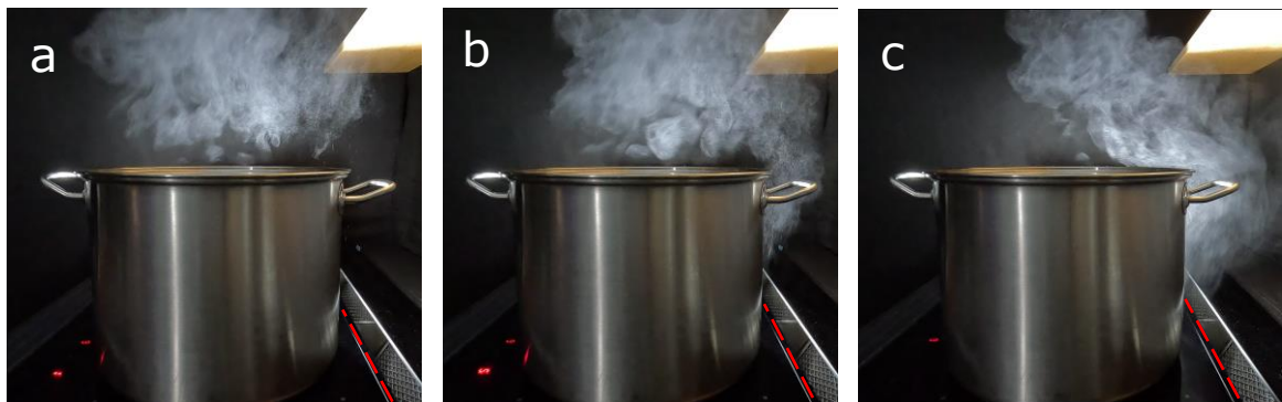
Joonis 5.6 Allatõmbega köögikubu veeauru äratõmbe visualiseerimine kasutades 22 cm kõrgust potti (a- 61 l/s; b- 103 l/s; c- 142 l/s) [Video link]
