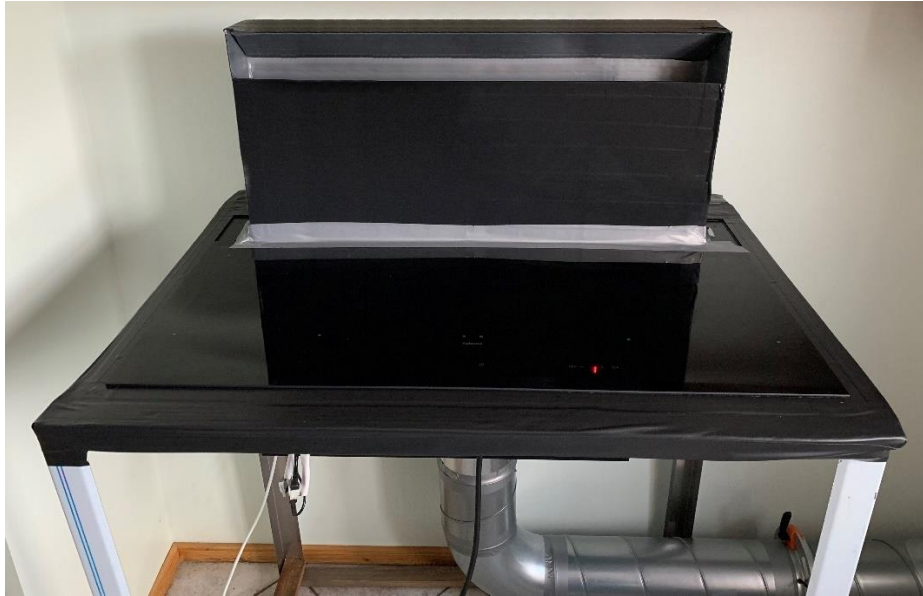
Joonis 4.5 Foto allatõmbega köögikubule lisatud teleskoobist
