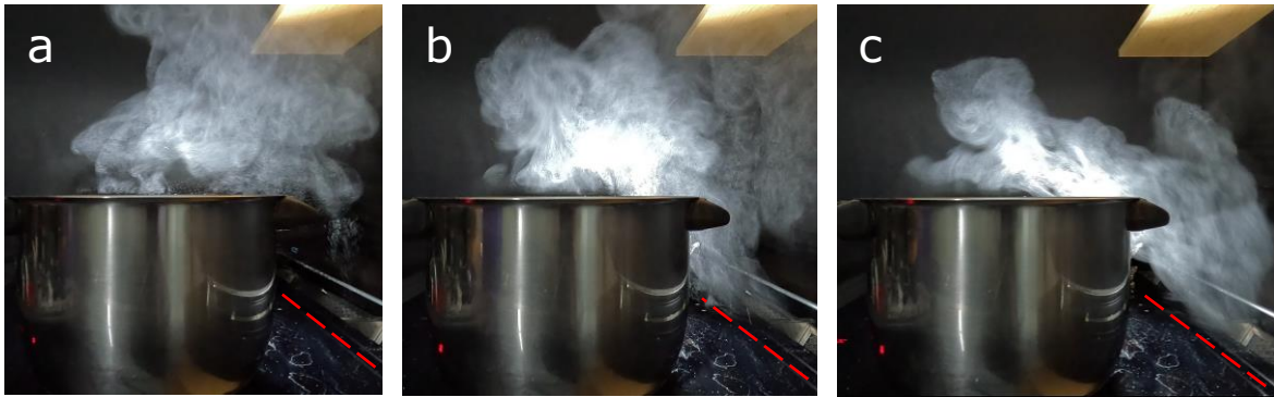
Joonis 5.5 Allatõmbega köögikubu veeauru äratõmbe visualiseerimine kasutades 13 cm kõrgust potti (a- 61 l/s; b- 103 l/s; c- 142 l/s) [Video link]
