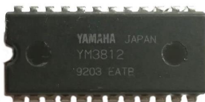
Joonis 5. Programmeeritav heligeneraator YM3812.
