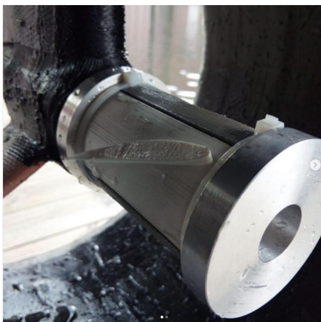
Joonis 8. TU Hamburg vesijalgratas "Emperor" purunenud sõukruvi (düüsiga).
