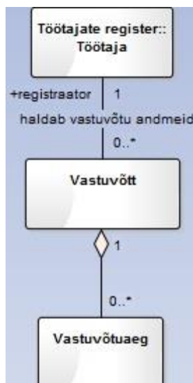
Joonis 15. Agregatsioon ja roll Enterprise Architect abil koostatud vastuvõtuaegade registri kontseptuaalel eskiismudelil
