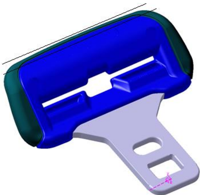
Joonis 20. Kirjeldatud pinna madaldamine 0,3 mm võrra.
