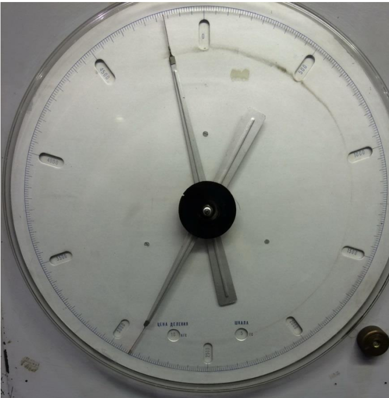
Joonis 80. Liikuva osutiga mõõteskaala.
