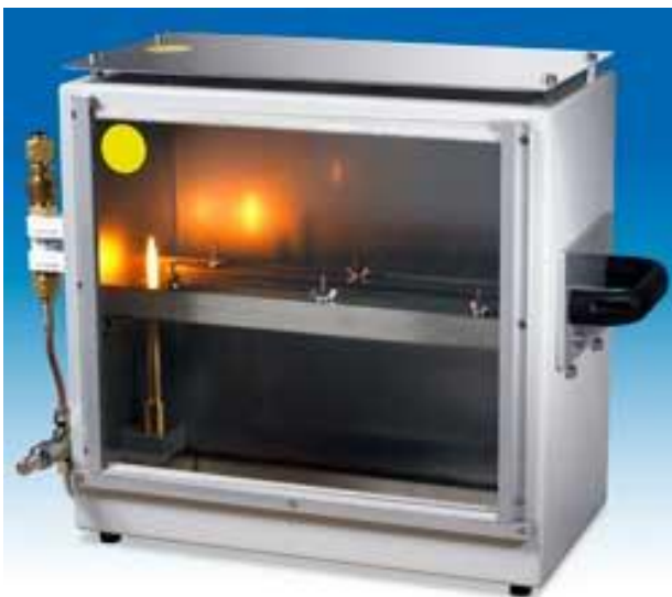
Joonis 81. Põlemiskamber FMVSS 302 [9] .
