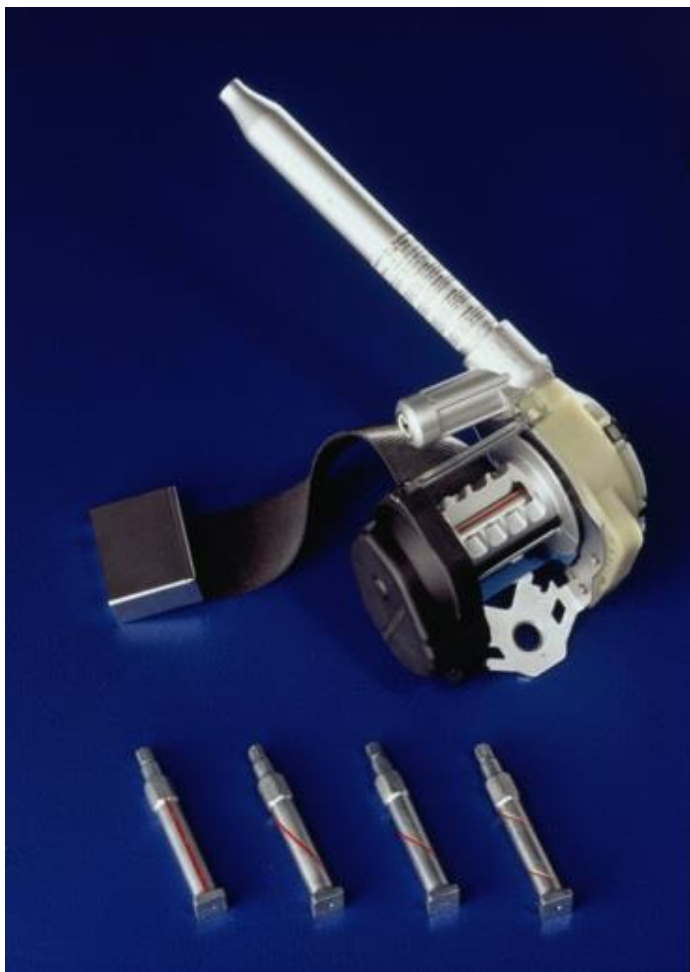
Joonis 6. Rihma inertsrollik püro-eelpinguti ja koormusepiirajaga. Punased märgid vardal näitavad, kuidas töötab üks kõige levinumatest koormuse piirajatest. Kui koormus rihmale ületab lubatava taseme, hakkab torsioon rihma lahti rullima [1] .
