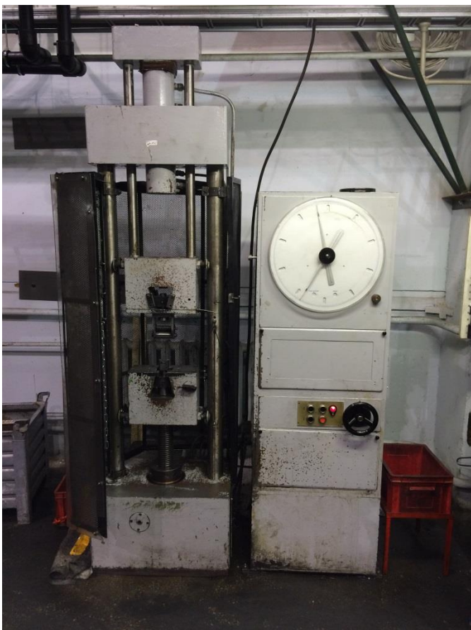
Joonis 77. Tõmbejõu mõõtmise seade.
