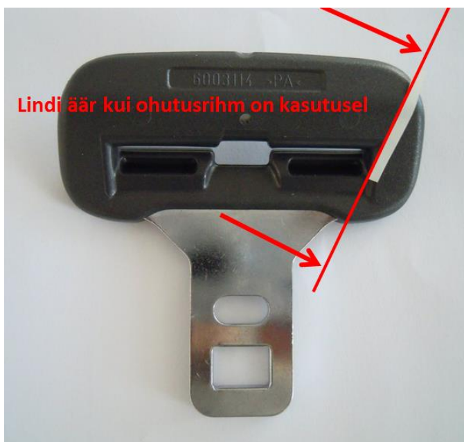
Joonis 16. Rihma serva asend turvavöö kasutamisel.
