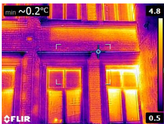
Joonis 3.17 Idafassaadi veranda taguse seinaga termopilt (autori foto)
