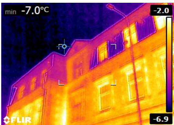
Joonis 3.22 Läänefassaadi soojustamata ja soojustatud (parempoolne) mansardkorruse termopilt (autori foto)
