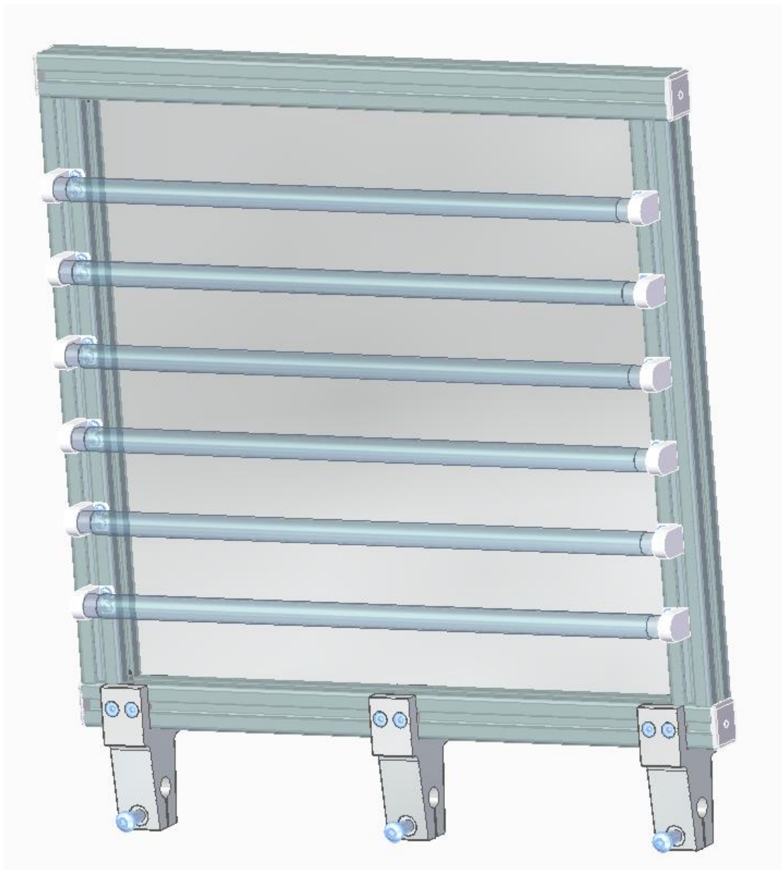
Joonis 7.1. Lampide paneeli viimane lahendus. Äärmised klambrid on keskele nihutatud, et tekitada ruumi lampide juhtmete vedamiseks mööda profiili soont.
