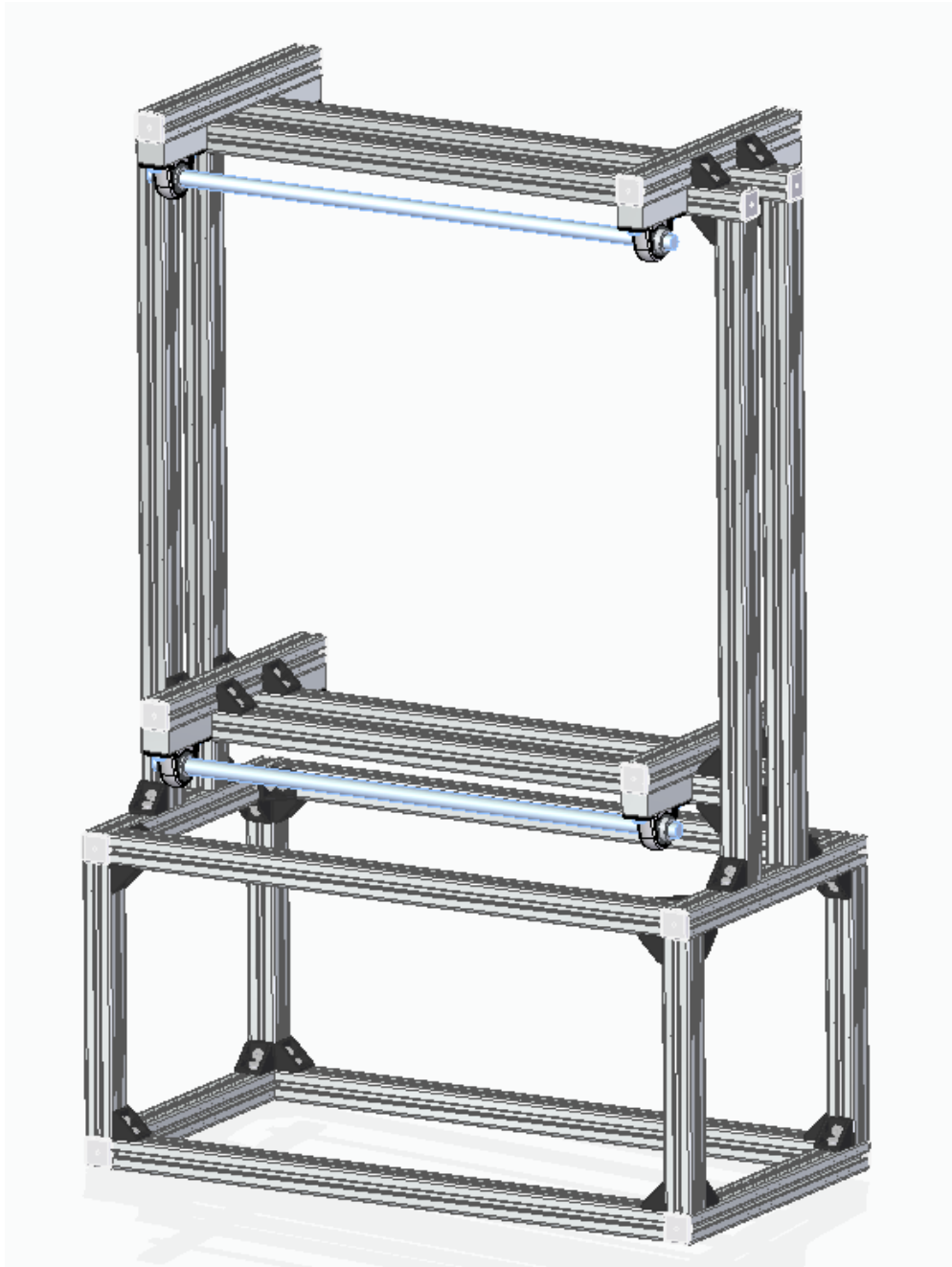
Joonis 7.9. UV-C roboti raam koos laagrite ja völlidega.
