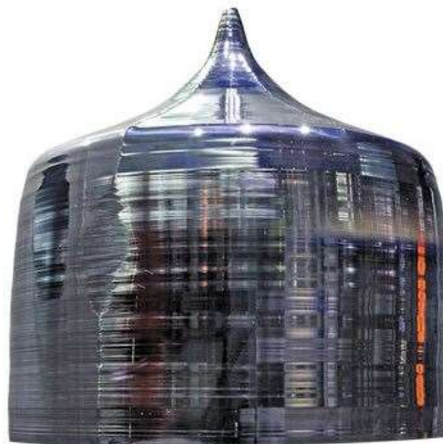
Joonis 1.3 Czochralski meetodil kasvatatud ränikristall. [3]
