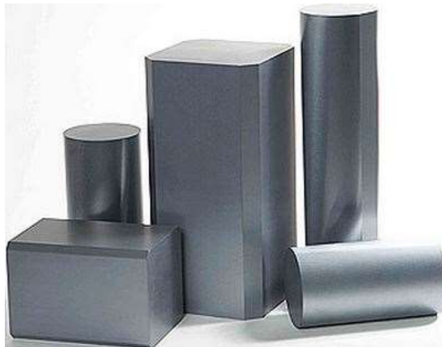
Joonis 1.4 Lõigatud räni kristall [3]
