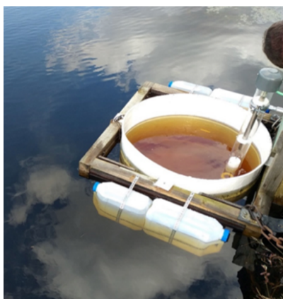
Joonis 1. Laukast aurumise mõõteseadeldis VDM-100, mis paigaldati 2021 aasta kevadel Tooma soojaama (Miina Krabbi, isiklik suhtlus, 17.02.2026).
