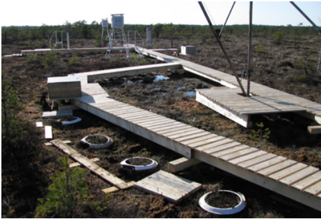
Joonis 2. GGI-B-1000 tüüpi soopinna aurumise mõõtevahend, mis oli Toomal kasutuses aastatel 1960-2024 (Miina Krabbi, isiklik suhtlus, 17.02.2026).
