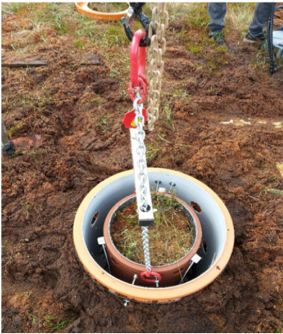
Joonis 3. 2024 aasta juunis paigaldatud uus soopinna aurumise mõõteseadeldis, mis teostab mõõtmisi ööpäevaringselt (Miina Krabbi, isiklik suhtlus, 17.02.2026).
