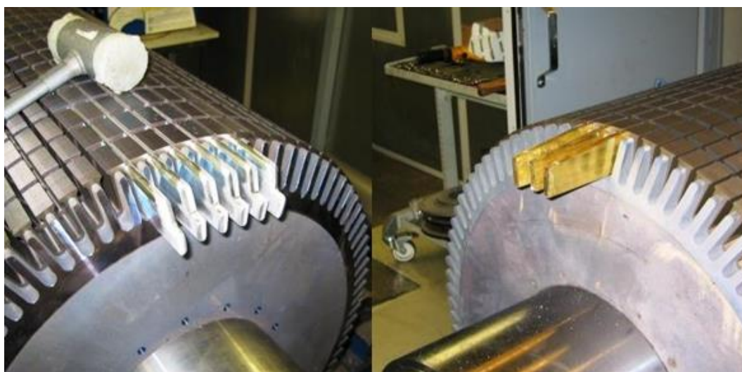
Рисунок 1.6. Установка алюминиевых и медных стержней
