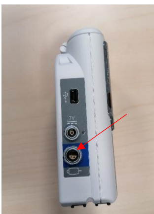
[Pilt 4] – pumba vasak külg, noolega on tähistatud puldipesa
