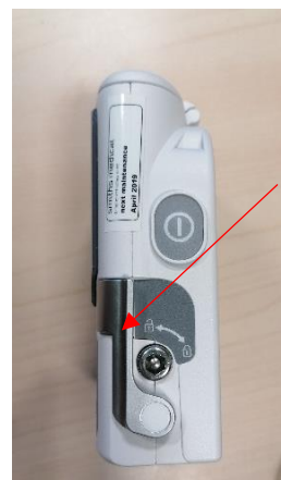
[Pilt 5] – pumba parem külg, noolega on tähistatud kassetiriiv
