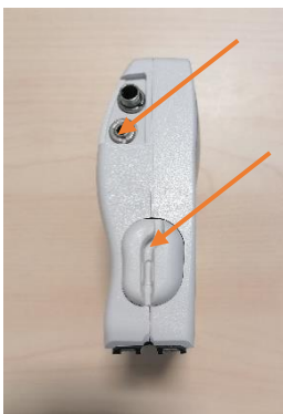
[Pilt 4] – pumba vasak külg, noolega on tähistatud õhudektori klambrid ja puldipesa
