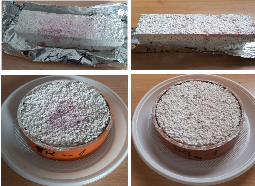
Joonis 4.1.5 Fenoolftaleiiniga kontrollitud ca kahe kuu vanuste (06.04.22) katsekehade pealmine pind (vasakul \text{CO}_2 -ga rikastamata, paremal \text{CO}_2 -ga rikastatud katsekehad)
