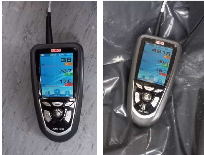
Joonis 3.2.4 Süsihappegaasi kontsentratsiooni mõõtmine õhus: a) minimaalne väärtus ilma värskes õhu ja/või CO 2 juurdepääsuta; b) CO 2 rikastatult
