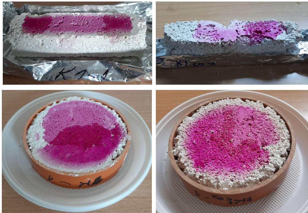
Joonis 4.1.6 Fenoolftaleiiniga kontrollitud ca kahe kuu vanuste (06.04.22) katsekehade alumine pind (vasakul \text{CO}_2 -ga rikastamata, paremal \text{CO}_2 -ga rikastatud katsekehad)
