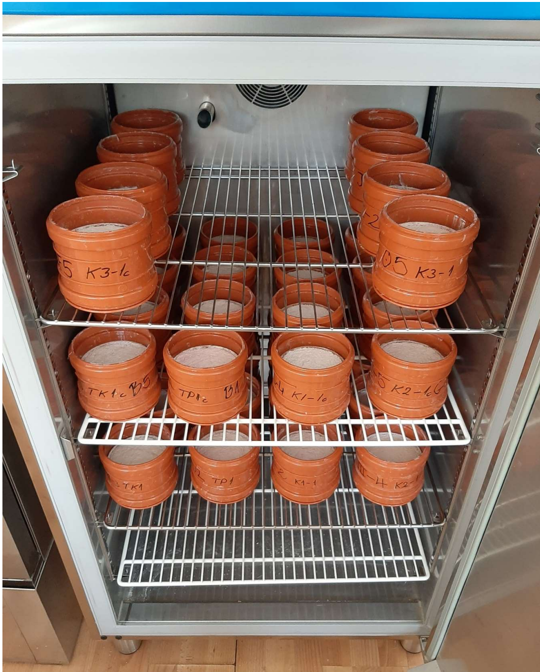
Joonis L3.3.4 Katsekehad kliimakambris veeauruläbivuse katsel
