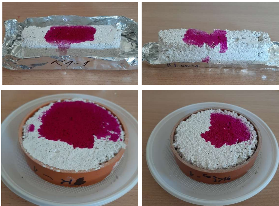
Joonis 4.1.4 Fenoolftaleiiniga kontrollitud ca ühe kuu vanuste (14.03.22) katsekehade alumine pind (vasakul CO_2 -ga rikastamata, paremal CO_2 -ga rikastatud katsekehad)
