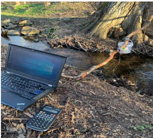
Joonis 15. Radar, mis on asetatud oja kohale vee voolukiiruse mõõtmiseks
