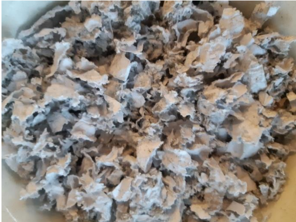
Joonis 3.6 Oma purustiga purustatud milline paber
