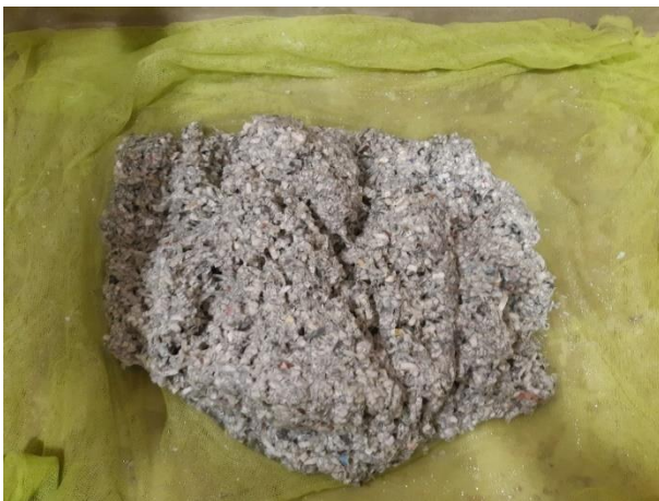
Joonis 3.7. Paberihundiga purustatud raamatupaber (kurnatud)
