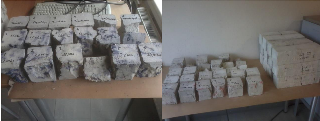
Joonis 4.5 Katsekehad pärast koormamist
