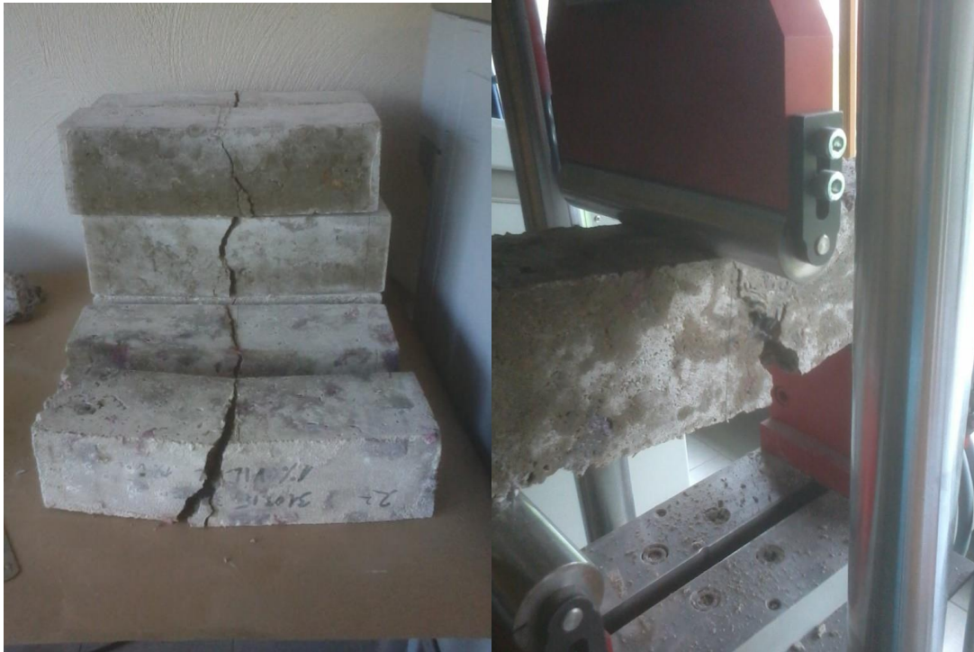
Joonis 3.9. ;3.10. Paindekatskehad pärast koormamist
