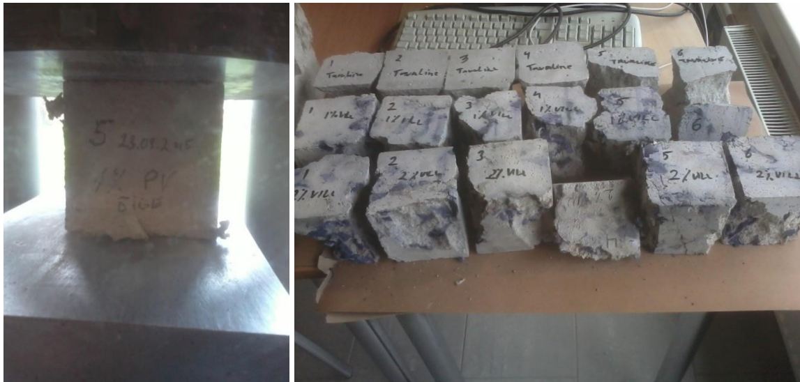
Joonis 3.7. ; 3.8. Survetugevuse katsekehad koormamise ajal ja pärast koormamist
