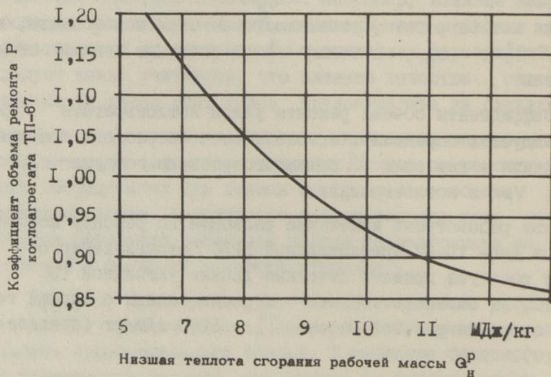
Фиг. 2. Зависимость коэффициента объема ремонта котлоагрегата ТП-67 от теплоты сгорания сланцев.
