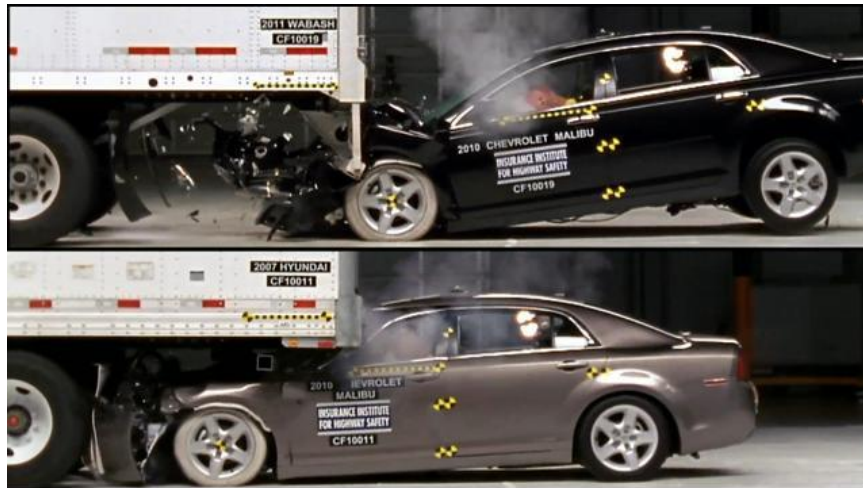
Joonis 34. Toimiv (üleval) ja mittetoimiv (all) allasõidutõke [33]
