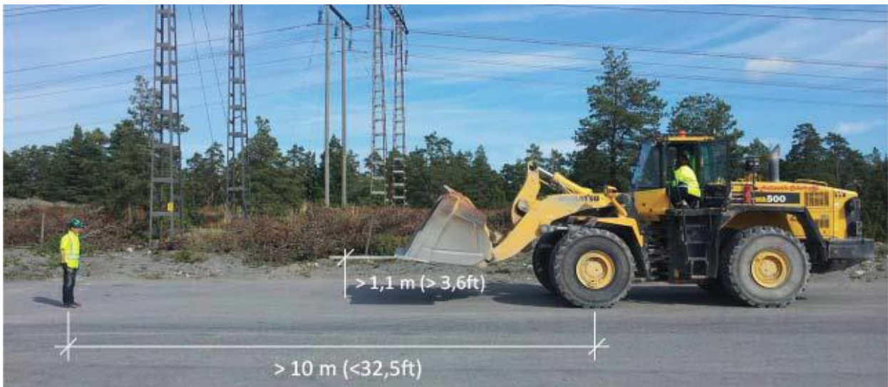
Joonis 3.2 ohutusraadius rataslaaduri ümber ülestõstetud kopa puhul
