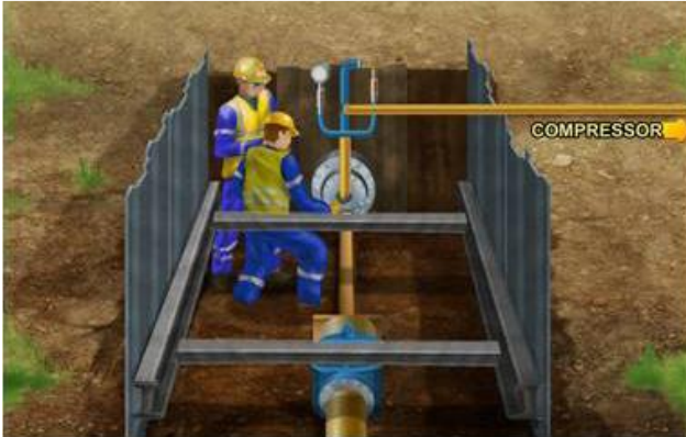
Joonis 2.1 Töömehed paigaldamas kaevendis ajutist korki
