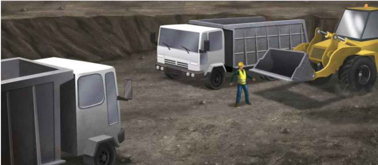
Joonis 3.1 Töötaja poole liikuv ülestõstetud kopaga laadur, mille juhi vaateväli oli piiratud
