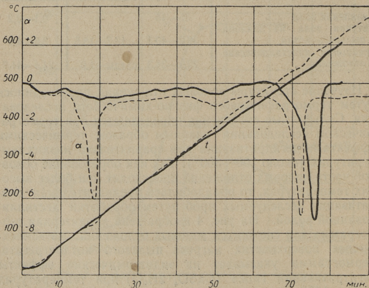
Рис. 5 — Термограмма летучей золы из батарейного циклона пылевого котлоагрегата. Проба гидратизирована. Содержание свободной извести равно 17,0\% .
