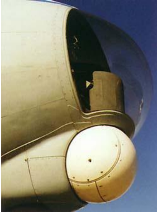
Sele 3.4. Lennukile kinnitatud IGUANE radar.
