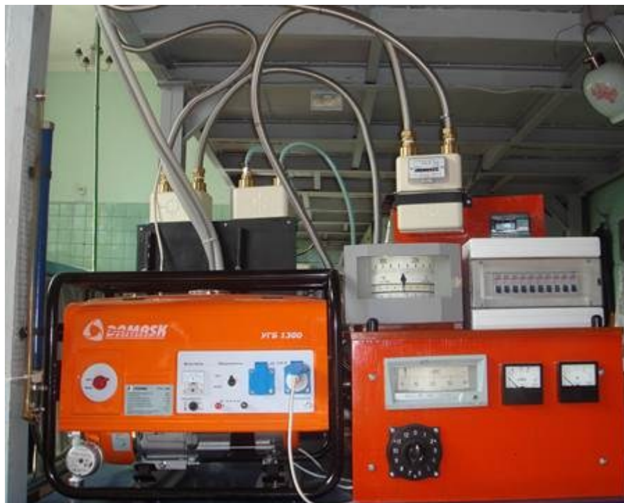
Joonis 5.1 Bensiinipõlemismootoriga elektrijaama katseseade [32]
