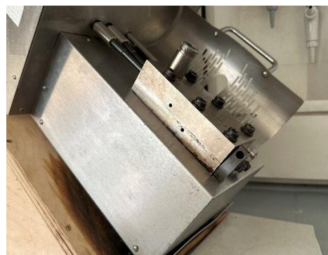
Joonis 3.2 Ekstruuder kokkupanduna. Allikas: autori pilt
