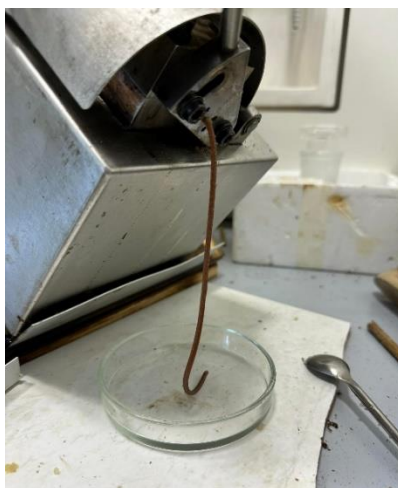
Joonis 3.3 Ekstruuderist väljuv tsellulooslauraadi filament. Allikas: autori pilt
