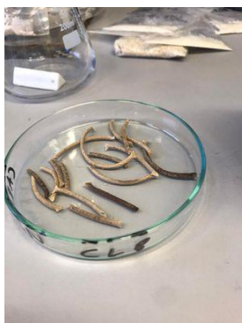
Joonis 3.4 Tükkideks lõigatud filament. Allikas: autori pilt
