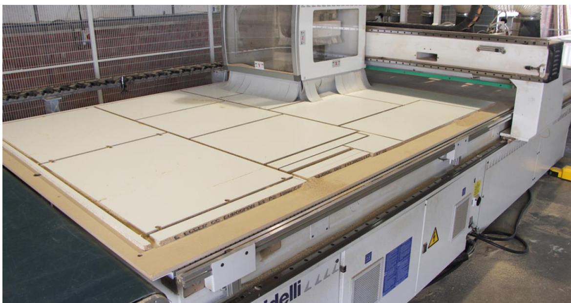
Joonis 1.3 Illustreeriv pilt CNC nesting pingist koos töödeldavate detailidega [16]
